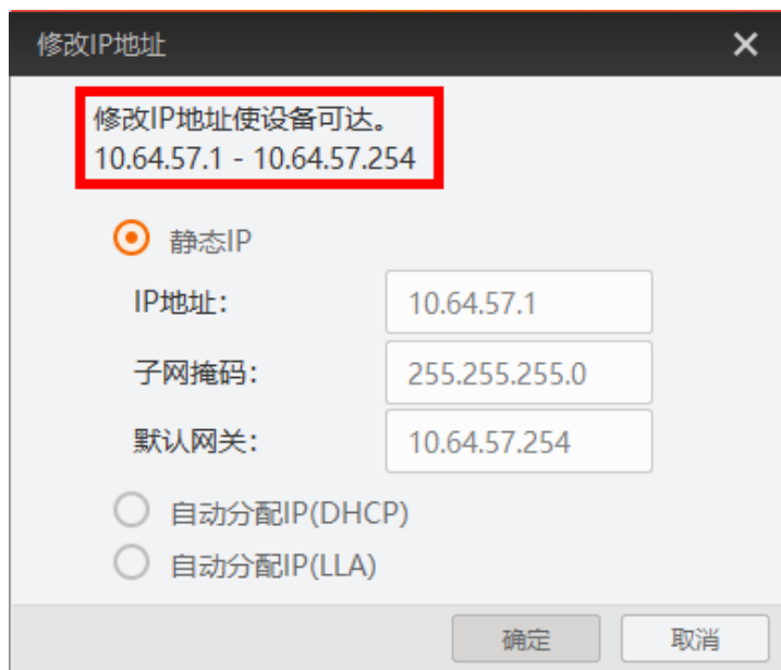
图2-7 修改 IP 地址
