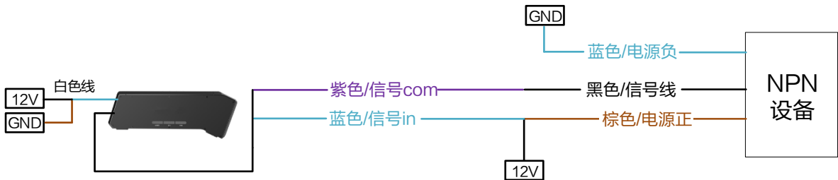
图6-6 输入信号接 NPN 设备（不使用上拉电阻）
