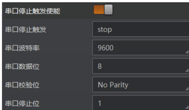
图3-40 串口停止触发
