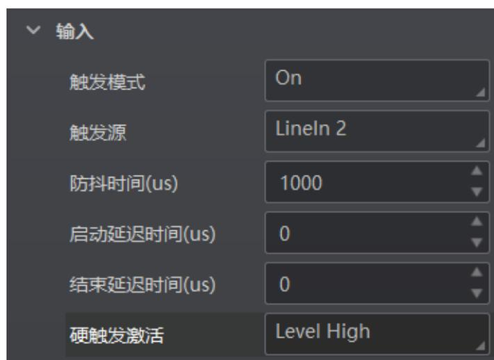
图3-30 高电平/低电平触发
