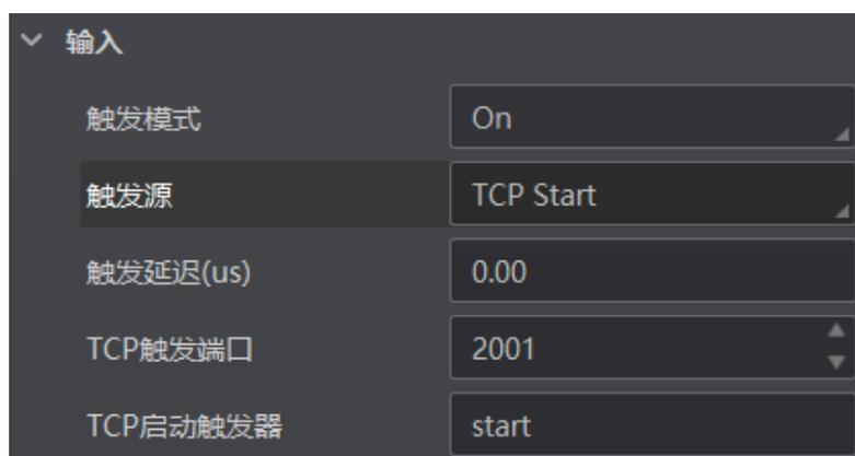
图3-32 TCP 触发参数设置
