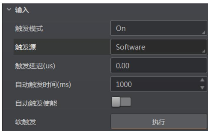
图3-27 软触发参数设置
