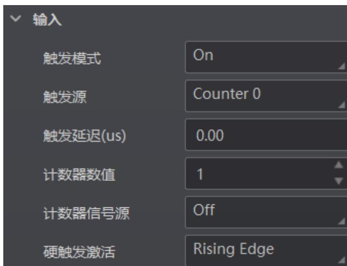
图3-31 计数器触发参数设置
