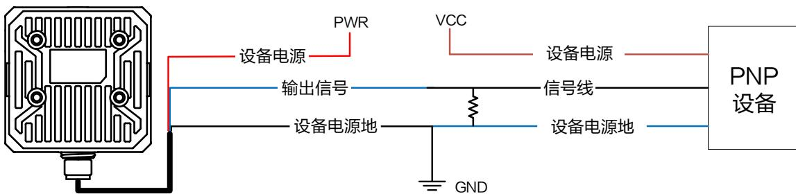
图4-8 输出信号接 PNP 设备
