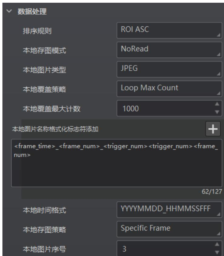
图3-67 SmartSDK 协议的数据处理
