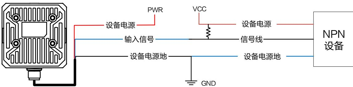
图4-6 输入信号接 NPN 设备
