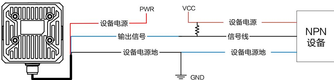
图4-9 输出信号接 NPN 设备
