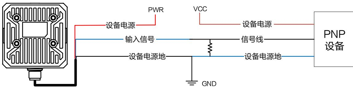
图4-5 输入信号接 PNP 设备
