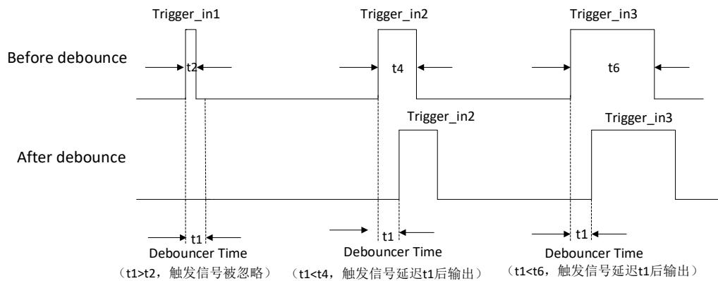
图3-42 触发输入信号去抖时序
