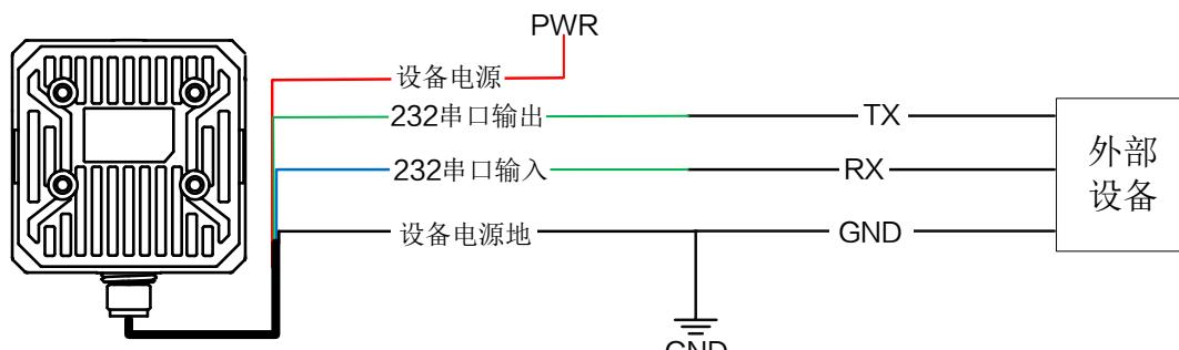
图4-12 RS-232 串口接线
