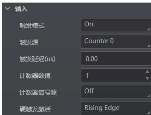
图4-42 计数器触发参数设置
