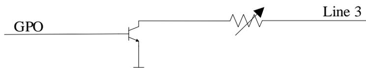
图5-13 Line 3 内部电路
