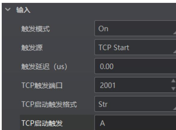
图4-43 TCP 触发参数设置
