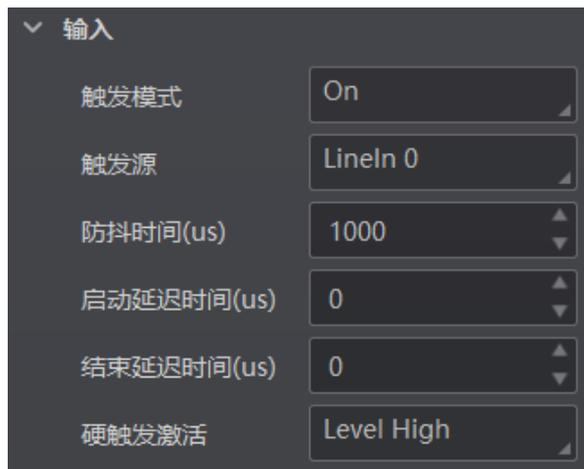
图4-41 高电平/低电平触发
