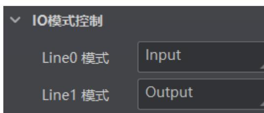
图4-36 设置输入/输出信号
