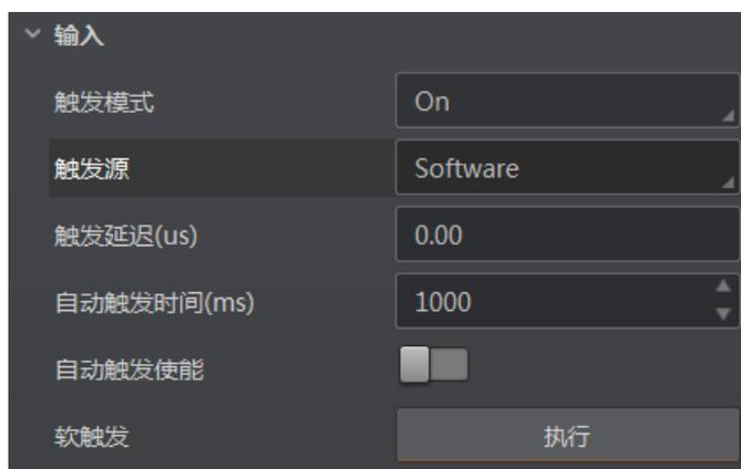
图4-38 软触发参数设置
