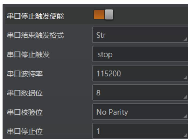
图4-53 串口停止触发
