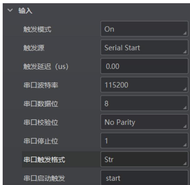
图4-45 串口触发参数设置
