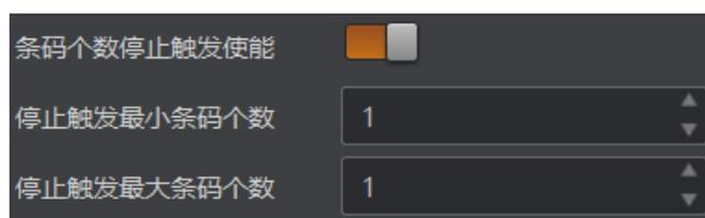
图4-56 条码个数停止触发
