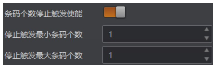
图4-61 条码个数停止触发
