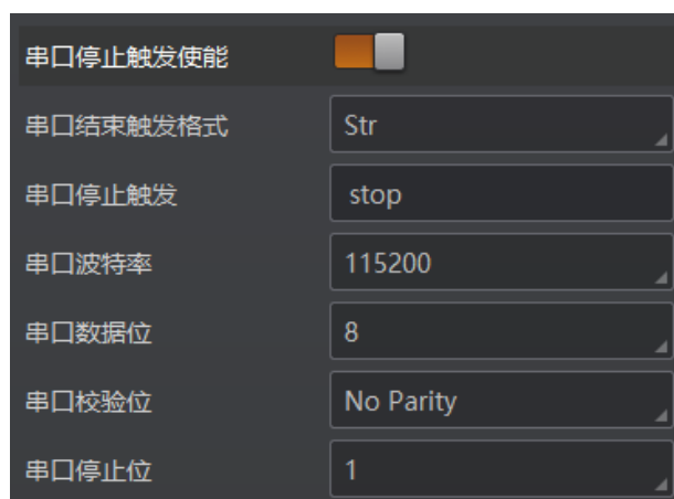
图4-59 串口停止触发
