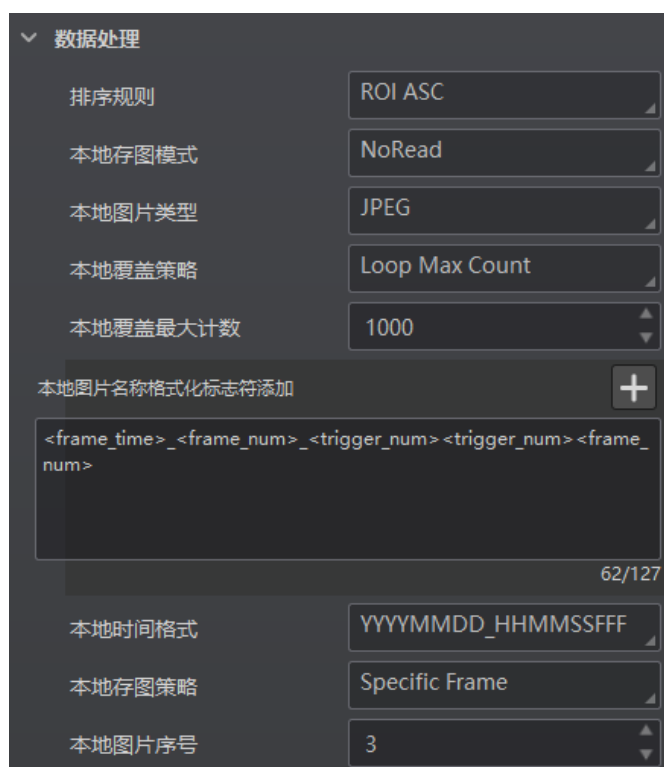
图4-90 SmartSDK 协议的数据处理
