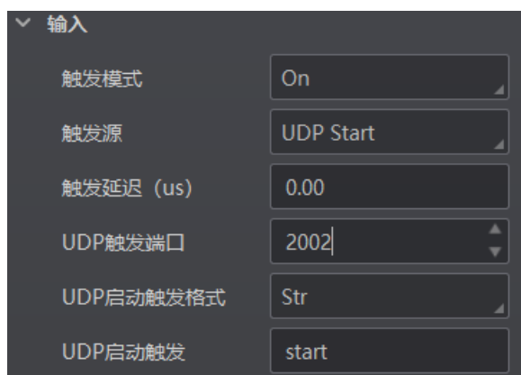
图4-51 UDP 触发参数设置
