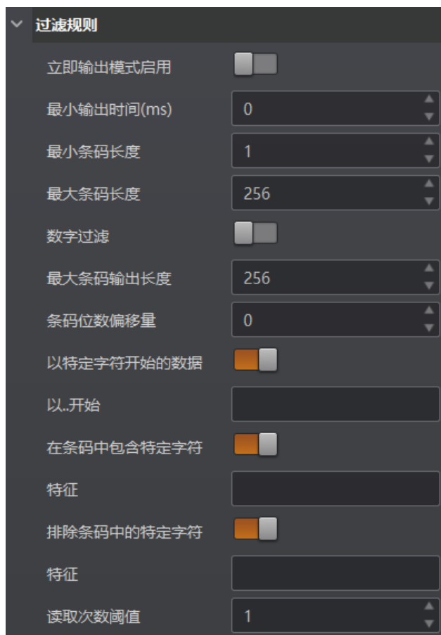
图4-86 普通过滤模式过滤规则参数
