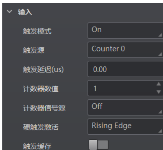
图4-49 计数器触发参数设置
