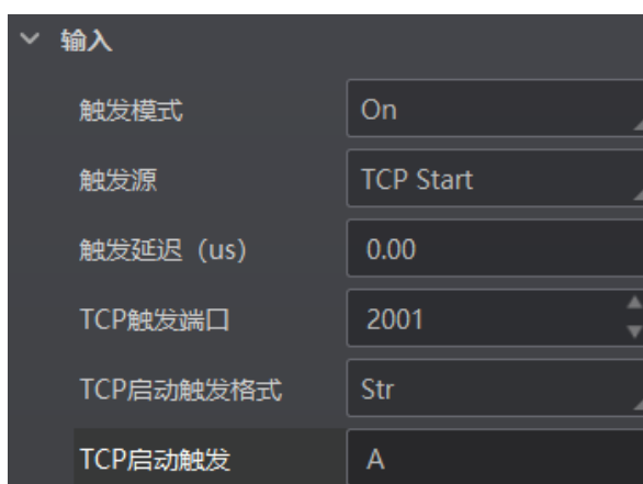
图4-50 TCP 触发参数设置
