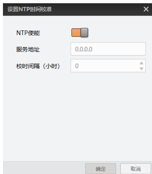
图4-94 NTP 时间校准设置
