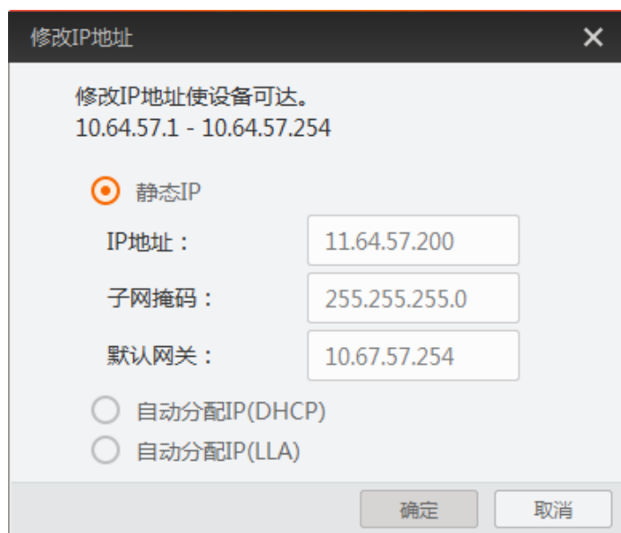
图3-9 修改 IP 地址
