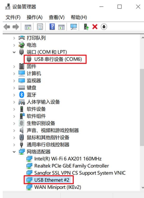
图3-15 设备驱动安装成功
