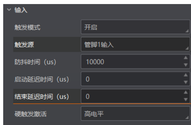
图4-25 硬件触发参数设置
