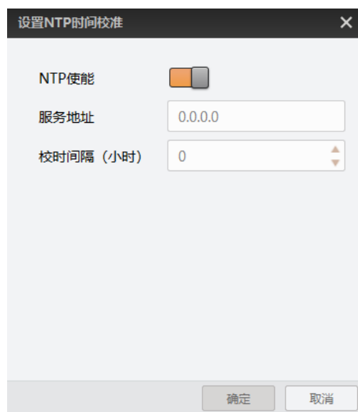
图4-43 NTP 时间校准设置
