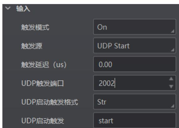
图5-44 UDP 触发参数设置
