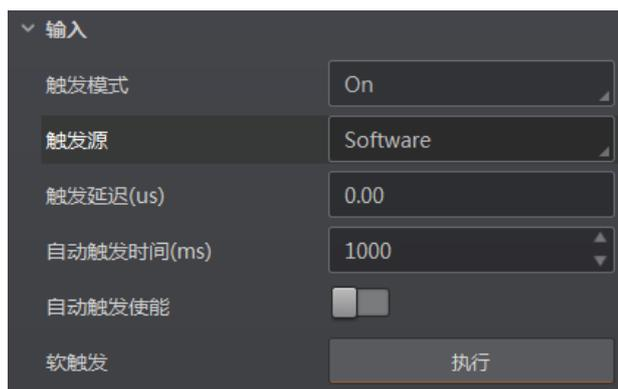
图5-38 软触发参数设置
