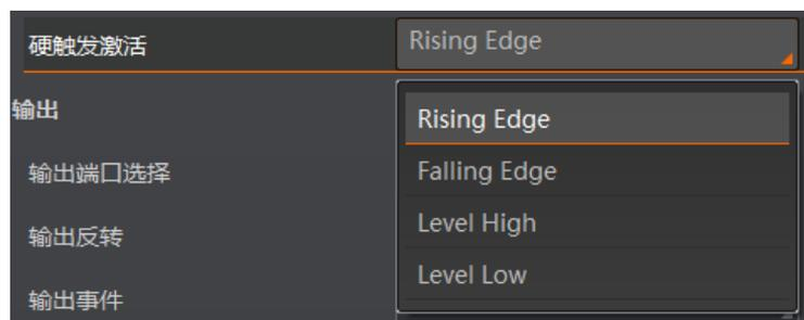
图5-41 外部触发参数触发方式设置
