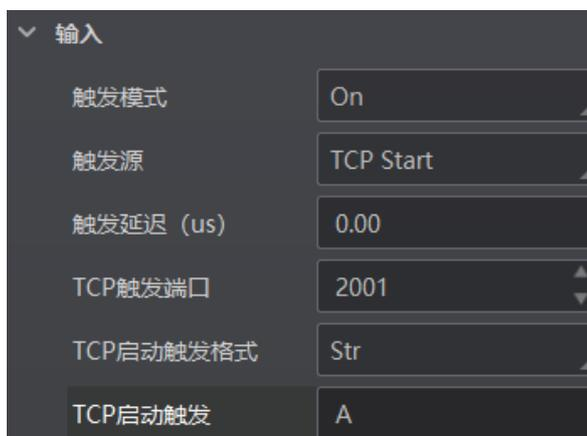
图5-43 TCP 触发参数设置
