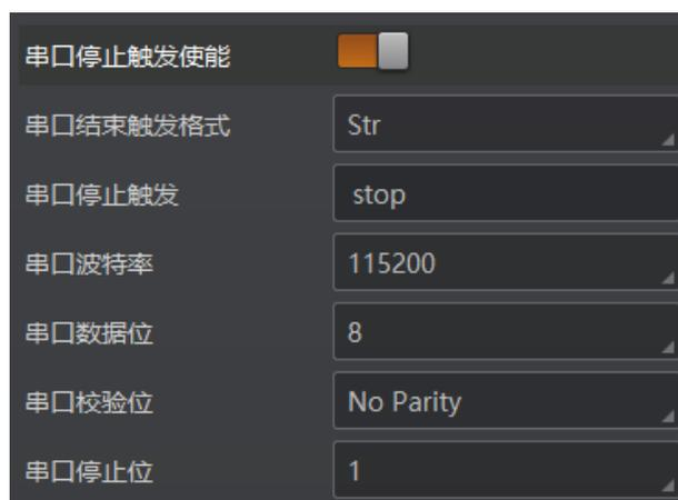
图5-53 串口停止触发
